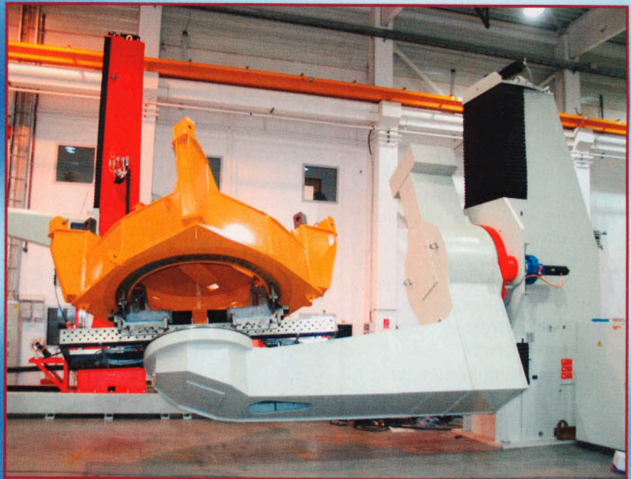
Mit seinem Dreharm, schwenkbar um 360 Grad, bewegt der L-Manipulator Lasten mit einem Gewicht von bis zu 10 000 kg präzise.
